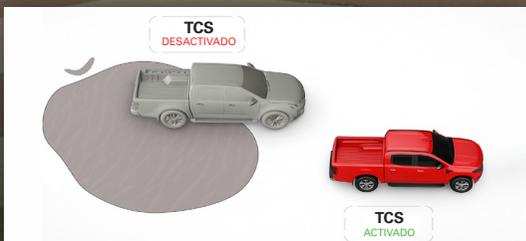
**TCS (Traction Control System).** El sistema TCS controla constantemente la tracción de las ruedas y ajusta automáticamente la potencia del motor y/o activa los frenos para evitar la pérdida de adherencia de las ruedas durante la aceleración, mejorando así la estabilidad y la tracción del vehículo sobre superficies resbaladizas o de baja adherencia.
