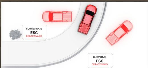
**ESC (Electronic Stability Control).** El sistema ESC controla constantemente la estabilidad del vehículo e interviene automáticamente frenando las ruedas individualmente o reduciendo la potencia del motor para evitar el subviraje o el sobreviraje, lo que ayuda a mantener el control del vehículo en situaciones de emergencia o en carreteras resbaladizas.
